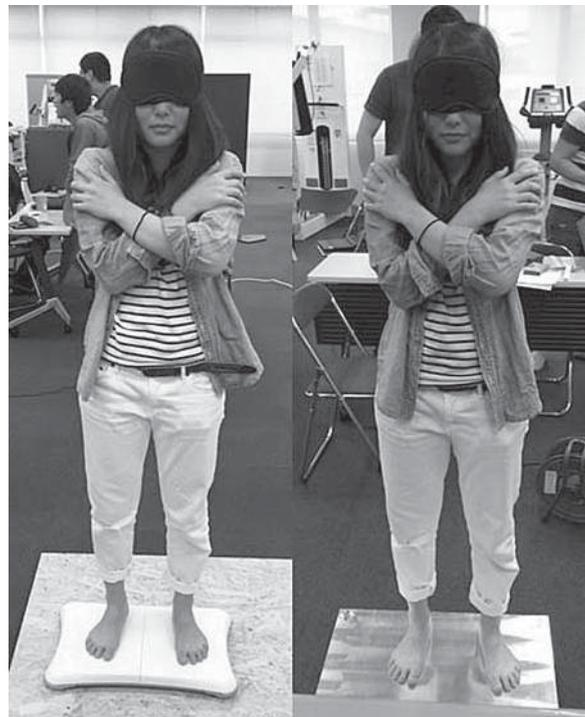
Fig.1: Wii Fit ボード（左図）ならびにフォースプレート（右図）を用いた重心動揺の測定
