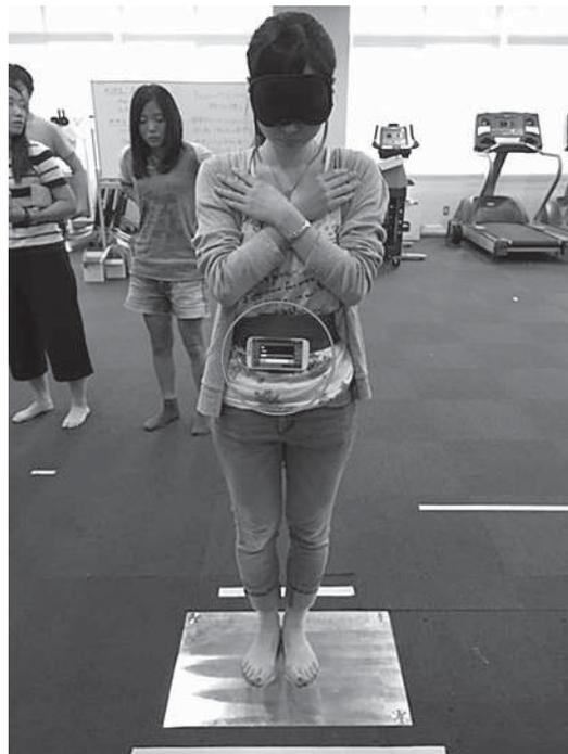
Fig.4: フォースプレートとスマートフォンを用いた加速度の測定：
